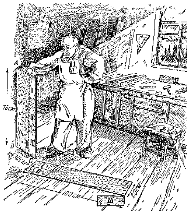
Figura 187. Como se alarga una tabla por el medio de tres cortes y una encoladura.
