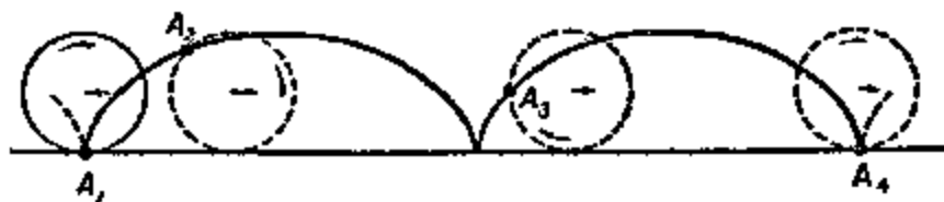
Figura 129. Cicloide – el trayecto del punto A del disco, corriendo sin deslizamiento sobre la rectilínea.
